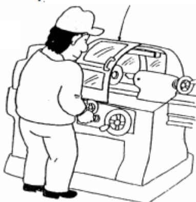
ภาพที่ 1.4 การออกแบบเครื่องจักรให้มีการป้องกันอันตราย
